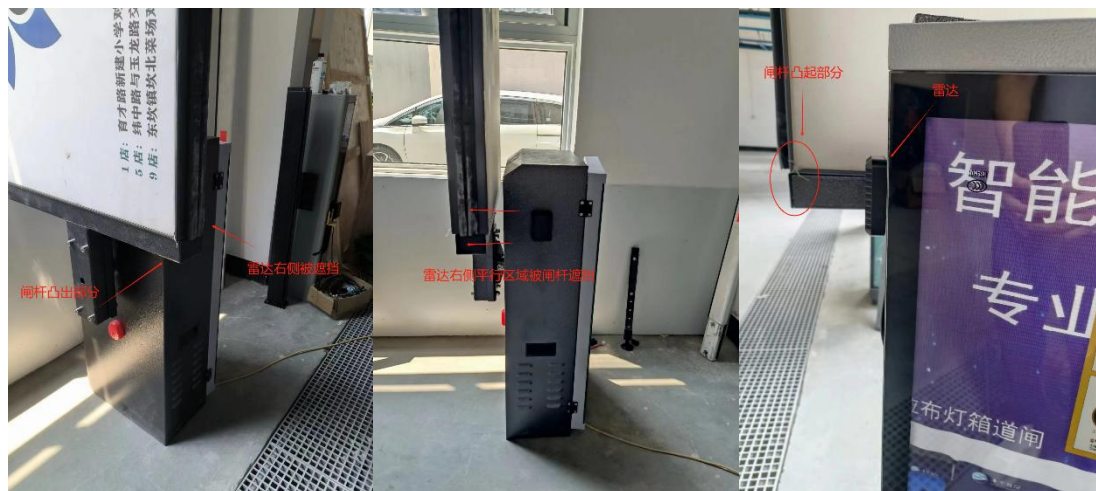
图 2 抬杆后雷达扇面被遮挡
